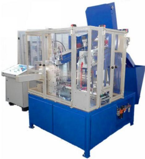
Máquina con sistema de **gestión de boquillas/cánulas totalmente automático**, que puede equiparse para trabajar con boquillas **con clip**, **sin clip** o **con dos estaciones** para poder trabajar con **ambos tipo** de boquillas.
