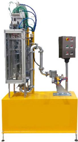
Modèles équipés de deux ou trois doseurs, pour colorer, ou pour couper/étendre le silicone avec du gel, ou pour colorer et catalyser, ou pour étendre le silicone avec du gel et le colorer, ou pour étendre le silicone avec du gel et le catalyser.
