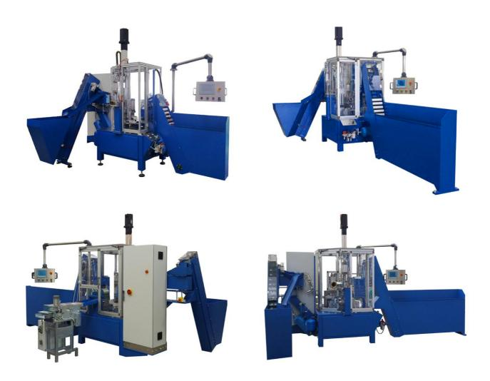
Pour le remplissage des mastics à haute et très haute viscosité en cartouches standard de 260 ml à 310 ml.
