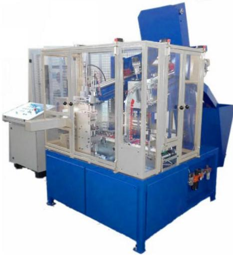
Machine avec système de **gestion des embouts entièrement automatique**, qui peut être équipée pour fonctionner avec des embouts **avec clip** ou **sans clip**, ou **avec deux stations** pour travailler avec les **deux types** d'embouts.
