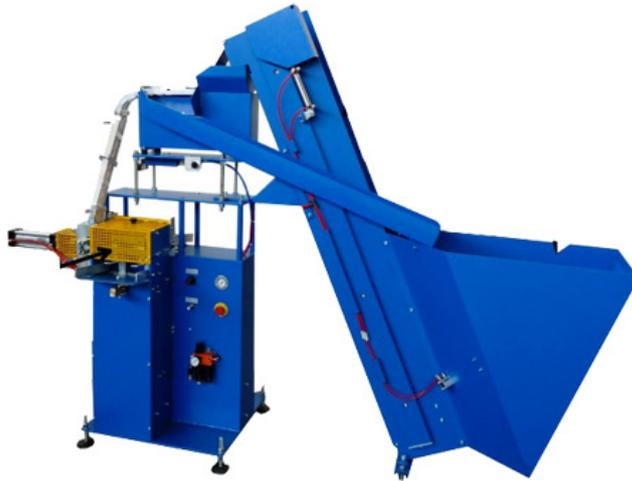
En ajoutant une rouleuse de cartouches Mod. GR et/ou une emballeuse semi-automatique mod. INSC, vous obtiendrez une ligne semi-automatique pouvant être gérée par deux opérateurs (un au remplissage de cartouches et l'autre à la fermeture et à la palettisation des cartons) pour une **productivité de 15-25 cartouches/minute**.
